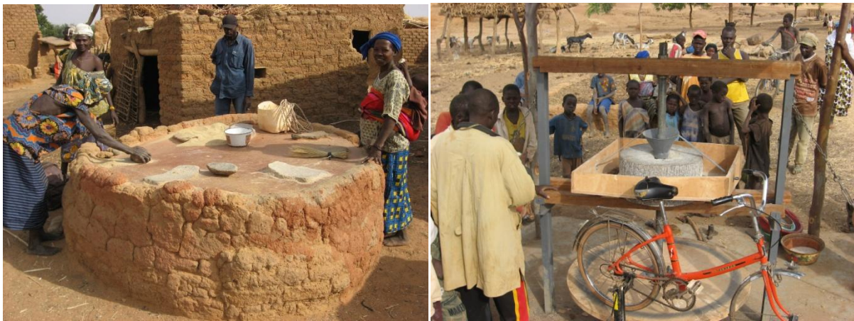
Abbildung 1 & 2: Die traditionelle Neeré, der Mahlplatz der Mossi Frauen war 2007 noch häufig genutzt. Die zu Beginn gefeierte Fahrradmühle konnte sich als Alternative auf Dauer nicht durchsetzen. Es fehlt die Akzeptanz.
