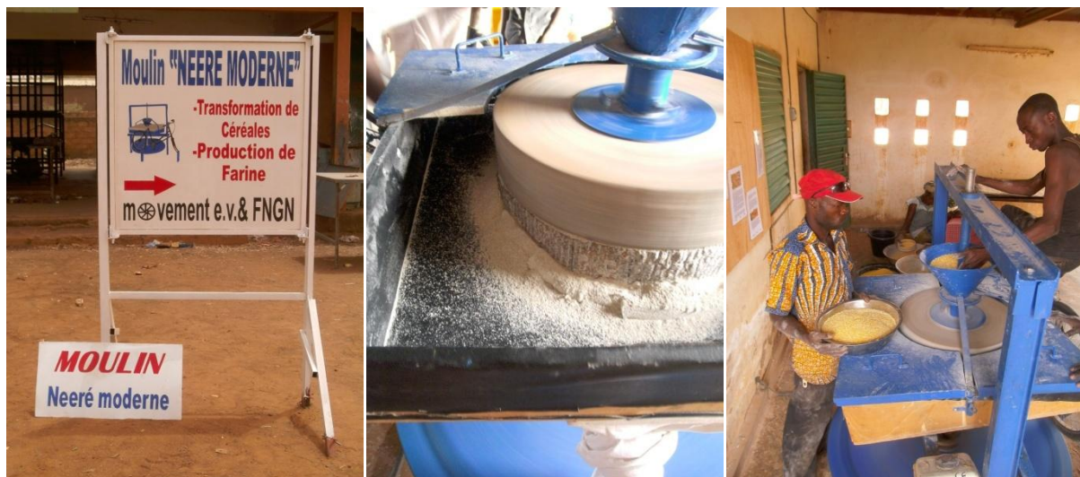
Abbildung 5-7: Die motorisierte Fahrradmühle wird bereits erfolgreich betrieben. Es wird Mehl und Couscous produziert.
