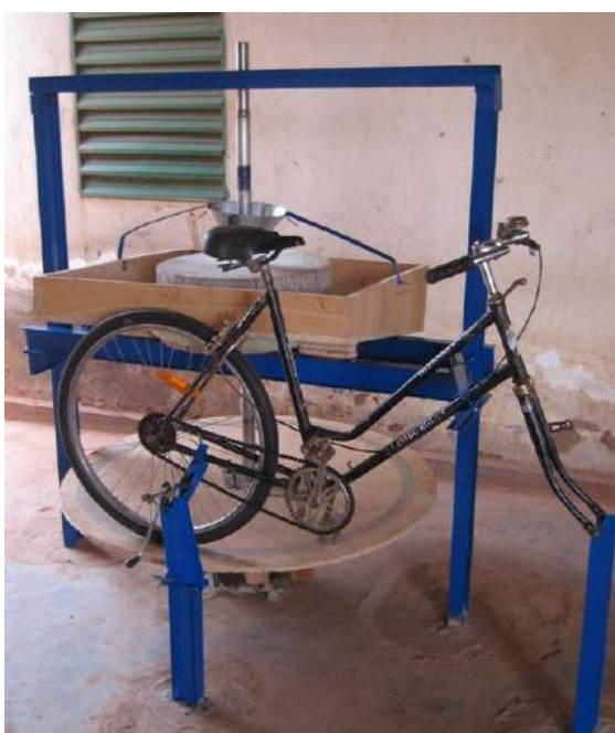
Abb. 7: Die verbesserte Version der Fahrradmühle. Abb. 8: Einfache Montage dank Einstellschrauben
