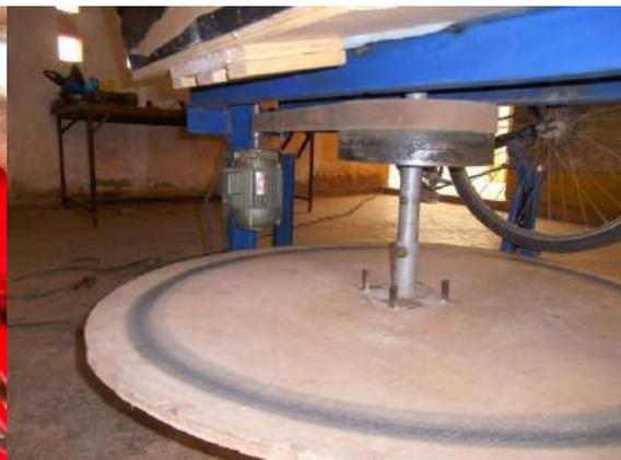
Abb. 4: Die ersten Versuche mit Elektromotor
