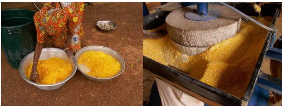
Abb. 5 & 6: Gelber Mais wird gewaschen und zu Couscous verarbeitet. Elektrisch angetrieben kann ein ganzer Sack Mais an einem Tag verarbeitet werden.
