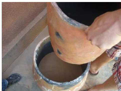
Fig. 9 : Le petit canari est déposé dans le grand canari.
