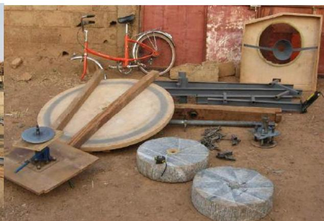
Abb. 10: Die fertige Fahrradmühle in Einzelteilen
