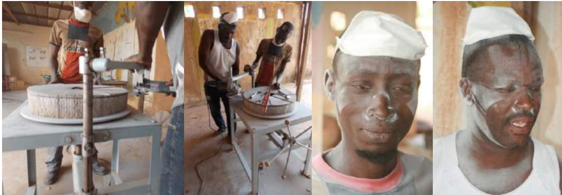
Abb. 25-28: Der Drehtisch erleichtert die Herstellung der Mühlsteine enorm, weshalb die Angelegenheit aber nicht weniger staubig ist.
