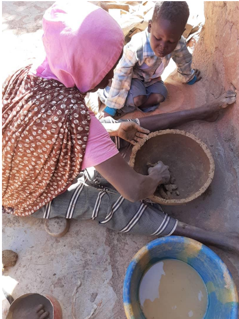
Abbildung 7: Vorbereitung des Lehms zur Herstellung eines Tonkrugkühlers
